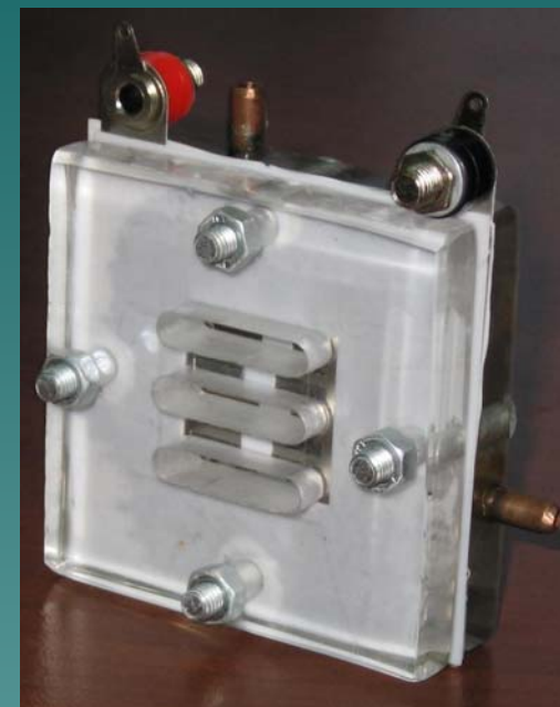
Макет выполнен совместно с ОП ИОНХ НАН Украины Рабочая поверхность электродов ТЭ 6,25 см 2
