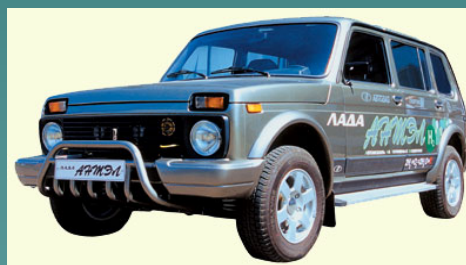
2001 г. Автомобиль «Нива» (Россия) на топливном элементе, разработанном для космического корабля «Буран»
