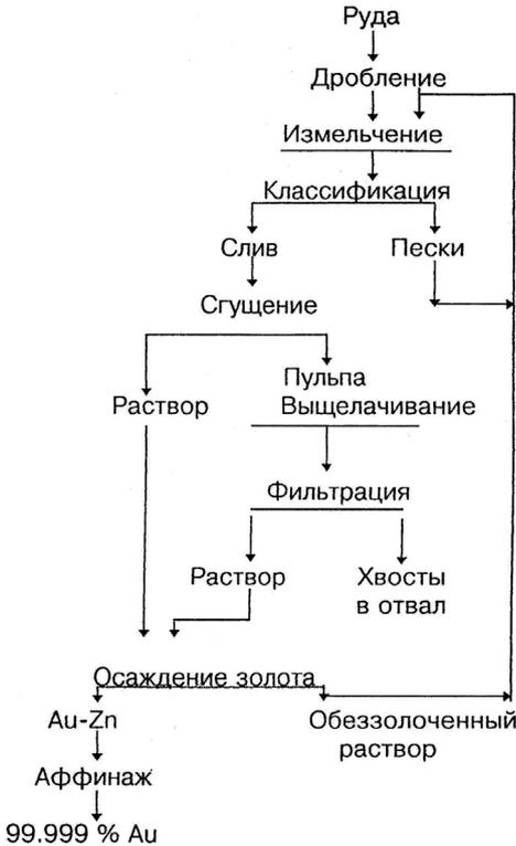
*Рис. 4.1. Типичная технологическая схема переработки золотосодержащей руды по [6].*
