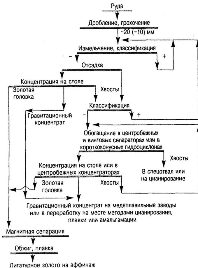
Рис. 4.10. Принципиальная гравитационная схема переработки золото-содержащих руд с получением лигатурного золота [33].
