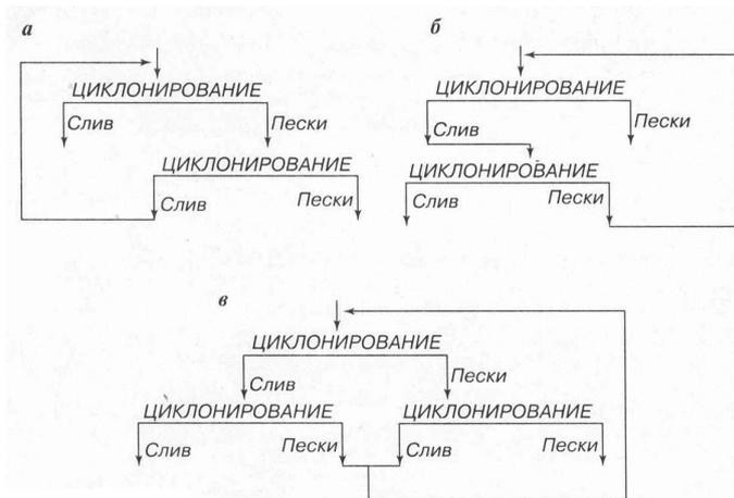
*Рис. 4.26. Схема соединения гидроциклонов с пересисткой песков (а), слива (б), с пересисткой и песков, и слива (в).*
