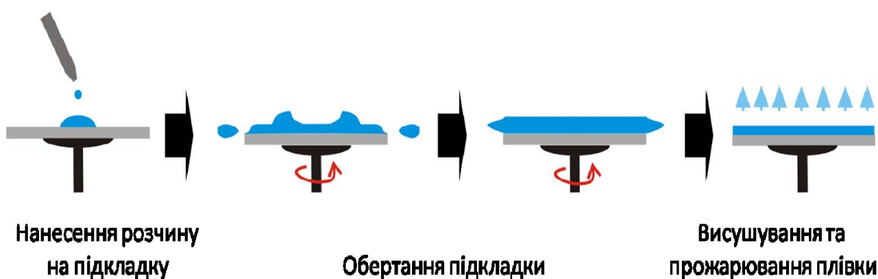
Рисунок 1.10 - Схема нанесення плівок методом spin coating [58]
