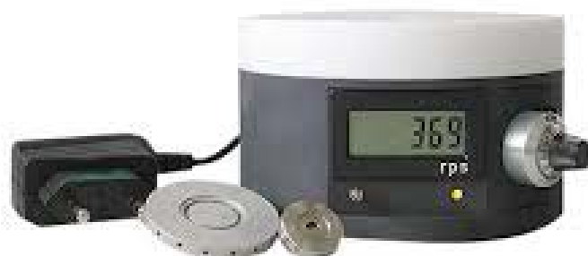
Рисунок 2.1 - SCI-20 – прилад для нанесення тонких плівок.
