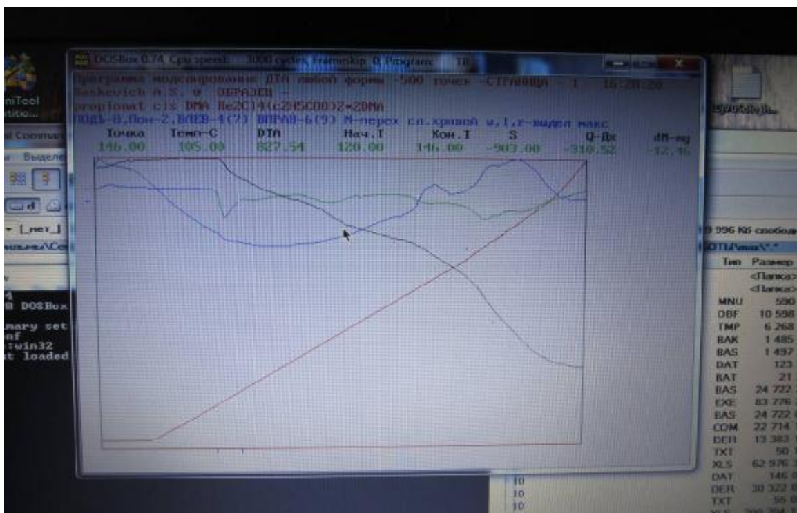
Рисунок 12 - Фрагмент роботи комплексу для визначення площі під кривою ДТГ
