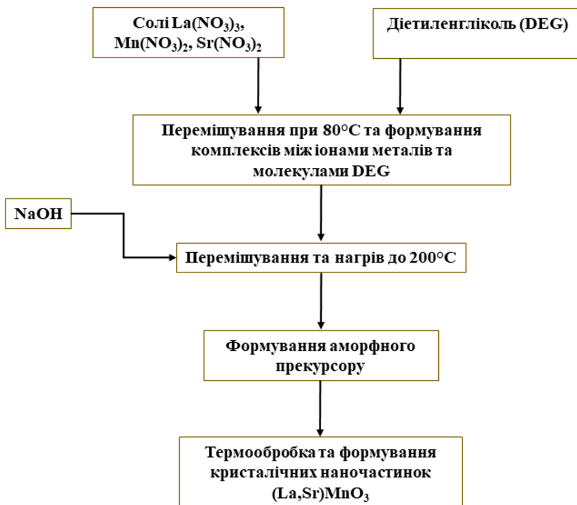
Рисунок 2.1. – Схема синтезу наночасток манганіту осадженням з розчину діетиленгліколю
