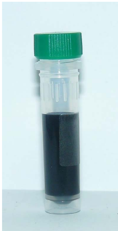
Рисунок 5.1 – Магнітна рідина на основі наночасток LSMO, синтезованих золь-гель методом, та водного розчину агарози
